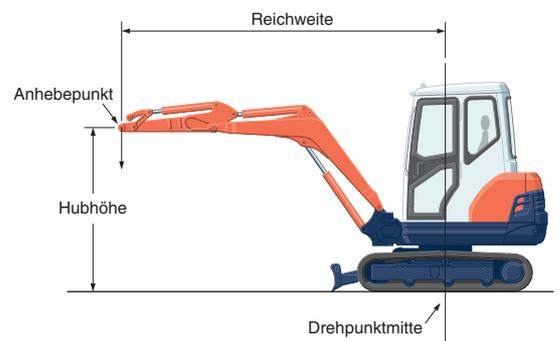
\* Die technischen Daten über den Arbeitsbereich der Maschine wurden mit dem Kubota Standard - Tieflöffel ermittelt, ohne Schnellwechseleinrichtung.
